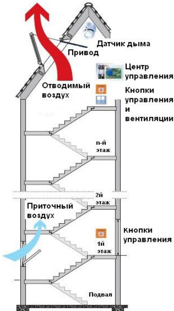
Система дымоудаления защищает жизнь людей, здание, материалы и оборудование от воздействия горячих и токсичных продуктов горения. Плотная завеса дыма, которая образовывается за короткое время после возникновения пожара, резко снижает видимость и ведет к возникновению паники при эвакуации.
